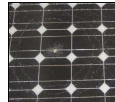
Test de résistance effectué sur un panneau solaire.
